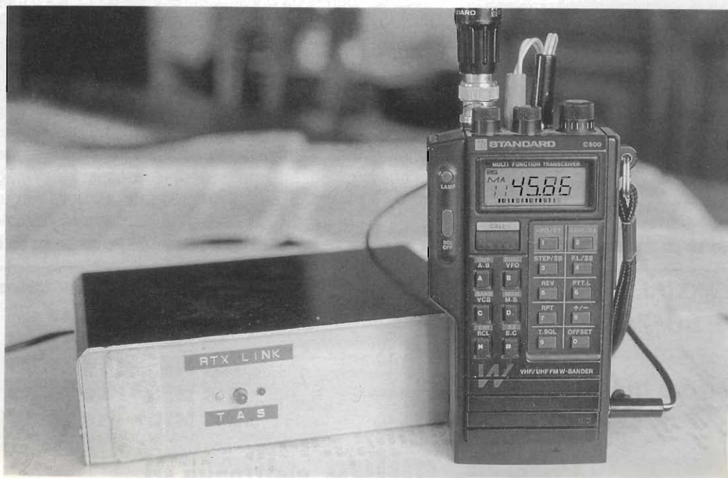
Foto 2 - Tono, Allarme, Segnale, tre LED. Volendo, si possono aggiungere quelli di ON/CHARGE/TX-ALL/BATT-LOW/...
