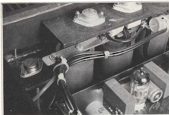
Particolare del montaggio dei MOSFET e di un transistor stabilizzatore; notare i cavi schermati che vanno dalla piastra DRIVER verso i MOSFET finali
