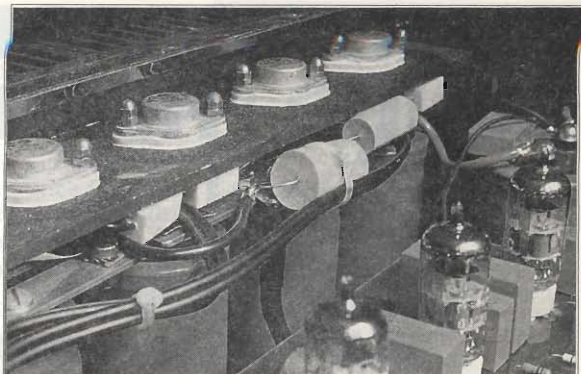
I MOSFET finali montati sopra un gruppo di elettrolitici di livellamento; notare anche C8-C9.
