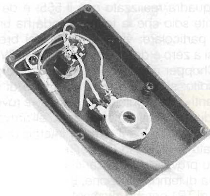
Foto - Interno del comando a distanza WAC (Walk Around Control). Magari ci si aspettava qualche componente in più, e invece...
