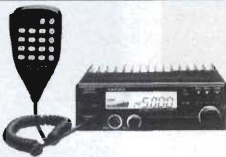
FT2400H - RxTx semiprofessionale, 50W RF e tono 1750 Hz
