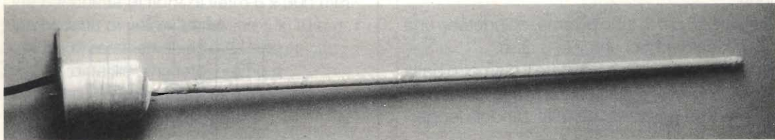
foto 5 - Antenna uso nautico: realizzazione ultimata
