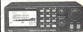
ICOM IC-R100 - Ricevitore a vasto spettro 100 kHz a 1856 MHz FM/AM.
