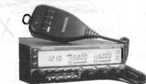
KENWOOD TM-741E RTX veicolare VHF/UHF FM multibanda - 144 MHz 430 MHz + terza banda optional (28 MHz; 50 MHz o 1,2 GHz) - 50 W in 144 MHz, 35 W 430 MHz.
