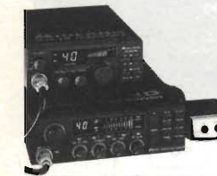
ALAN 18 - 28 - RTX veicolare 40 ch., 26965 - 27405 MHz - MIC/GAIN.
