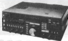
YAESU FT 736R Ricetrasmittore base All-mode bilanda VHF/UHF. Modi d'emissione: FM / USB / LSB / CW duplex e semiduplex. Potenza regolabile 2,5-60W (optionali moduli TX 50 MHz 220 MHz 1296 MHz). Alimentazione 220V. 100 memorie, scanner, steps a piacere Shift +/-600 +/-1600.
