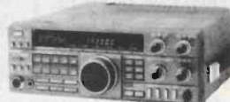
KENWOOD TS 440 S/AT Copre tutte le bande amatoriali da 100 kHz a 30 MHz - All Mode - Potenza RF - 100 W in AM - Acc. Incorp.
