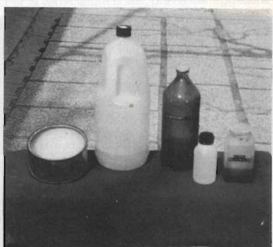
Alcuni materiali impiegati nella lavorazione: (da sinistra): cera distaccante solida, resina poliestere, cera distaccante liquida, catalizzatore ed alcool polivinilico.
