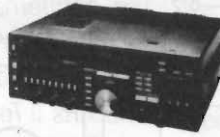
YAESU FT 736R Ricetrasmittitore base All-mode bbanda VHF/UHF. Modi d'emissione: FM / USB / LSB / CW duplex e semiduplex. Potenza regolabile 2,5 - 60W (opzionali moduli TX 50 MHz 220 MHz 1296 MHz). Alimentazione 220V. 100 memorie, scanner, steps a piacere Shift +/-600 +/-1600.
