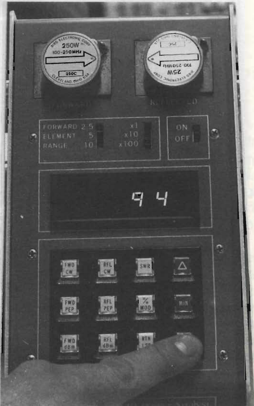
figura 4 - Potenza PEP sviluppata (su carico fittizio) in banda 2 m.
