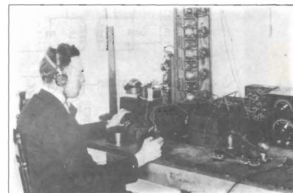
figura 1 - Paul Godley nel suo laboratorio di Montclair (N.J.) con la super-het poi usata ad Ardrossan. In verticale l'amplificatore di media frequenza a 5 stadi in cascata ad accoppiamento RC. All'estrema sinistra un ricevitore Paragon RA-6
