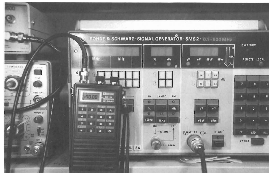
foto n. 8 - L'IC 04 al banco di prova. Il generatore è tarato per una uscita di 0,1 \mu V a 470 Mhz e come si potrà rilevare osservando lo S/meter del RTX lo squelch è bloccato. Stessa prova ovviamente è stata effettuata a passi di 10 Mhz su tutta la gamma.
