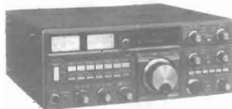
Ricetrasmittitore VHF/UHF per emissioni contemporanee in duplex, USB-LSB-CW-FM, potenza 10 W.
