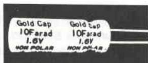
figura 2 - 10 farad è un valore di capacità estremamente elevato. Tuttavia oggi si producono condensatori di questo valore. Il condensatore mostrato nella foto è a grandezza naturale (3,7 cm).
