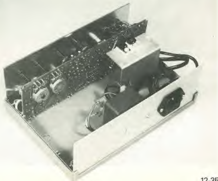
Figura 7. Fotografia del generatore di funzioni completamente montato, eccettuato il coperchio, che deve essere ancora applicato al mobiletto. Il cavo di rete attraversa il circuito stampato e da questo va all'interruttore di rete sul pannello frontale. I due regolatori di tensione (sul lato rame del circuito stampato) sono fissati su un dissipatore termico autocostituito. Il potenziometro a filo per la regolazione della frequenza è situato al di sotto del dissipatore termico.
