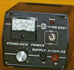
ALIMENTATORE STABILIZZATO 5+25 V 2A Mod. PK 005
