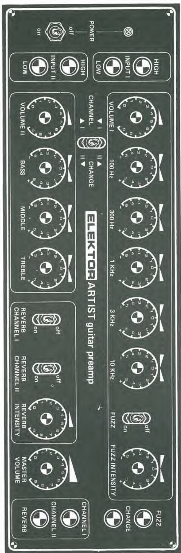
Figura 4. Una disposizione corretta dei componenti sul pannello frontale
