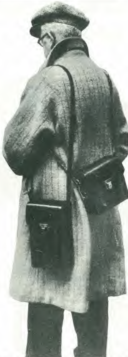
Figura 1. Il trasmettitore tedesco Agentenfunk, in due borse, di cui una per le batterie.
