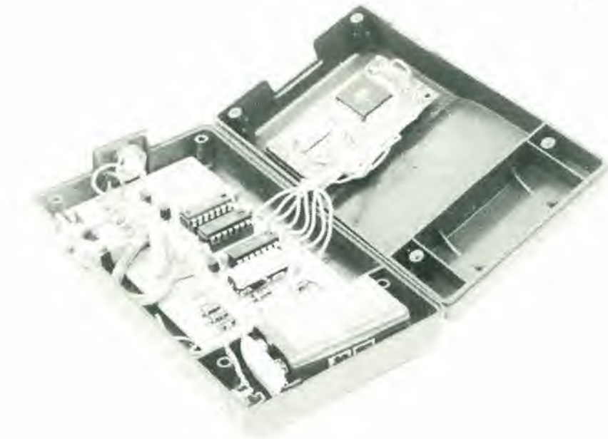
Fotografia. La basetta stampata del frequenzimetro ed il modulo sono stati progettati per l'inserzione nell'astuccio che si vede in foto.
