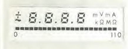
Fotografia 2. Una combinazione di valori analogici e digitali misurati usando gli LCD.
