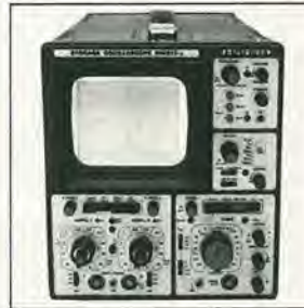
HM 812-2 5" - 50 MHz - 5 mV A memoria - Doppia traccia Ritardo deflessione Linea di ritardo
