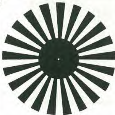
Figura 5. Il disco segmentato deve essere ritagliato ed incollato su di un disco di perspex.
