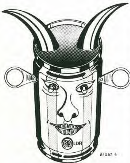
Figura 4. Il bersaglio può essere realizzato come si vede; sia la LDR che i LED devono essere affacciati sul fronte del simulacro possibilmente dipinto.
