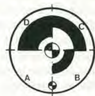
Figura 3. Dato che le informazioni che si devono ricavare costituiscono una indicazione logica a due-bit, il disco codificatore sarà piuttosto semplice.
