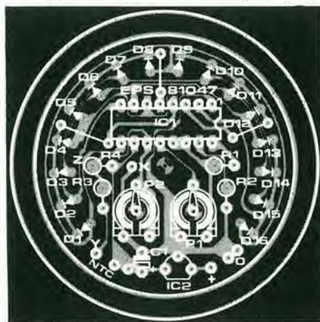
Figura 3. Il circuito stampato che si adotta per il termometro può servire anche per un altro impiego accennato nel testo.
