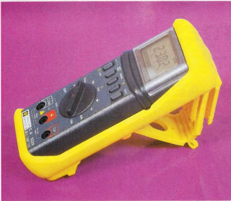
l'alternatif au continu, en tension et intensité. Elle permet également de sélectionner la fonction continuité ou résistance en mode ohmmètre.
