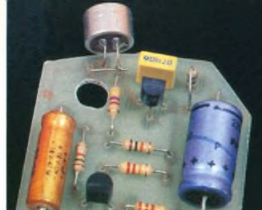
Photo 3. – Le micro-électret capte les sons à l'intérieur du véhicule.
