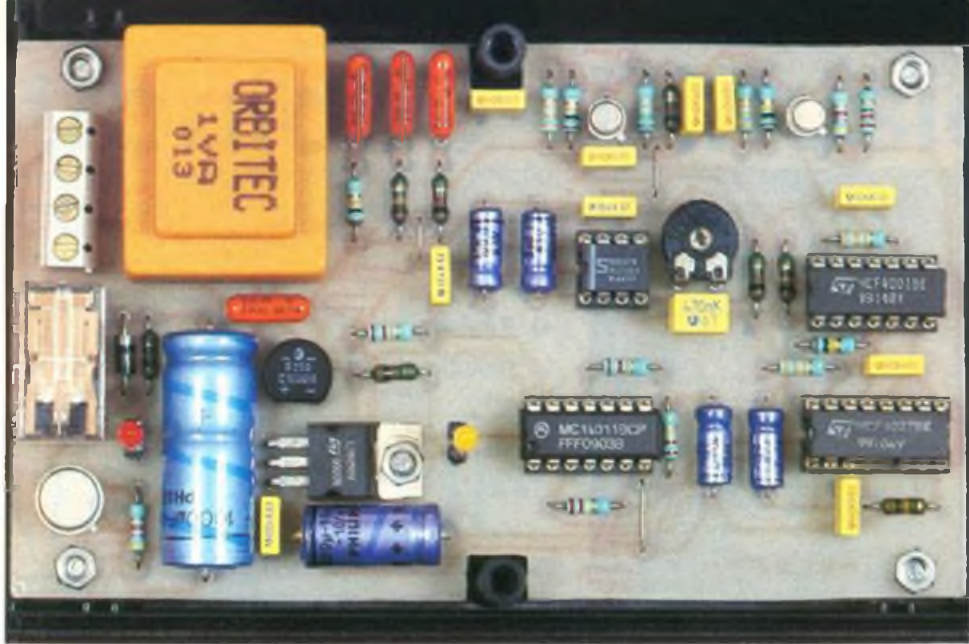
Photo 3 - Vue du récepteur prêt à l'emploi.
