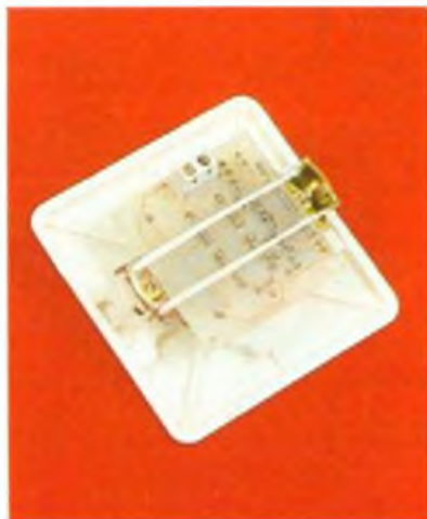
Photo 5. – L'émetteur se loge dans un boîtier encastrable.
