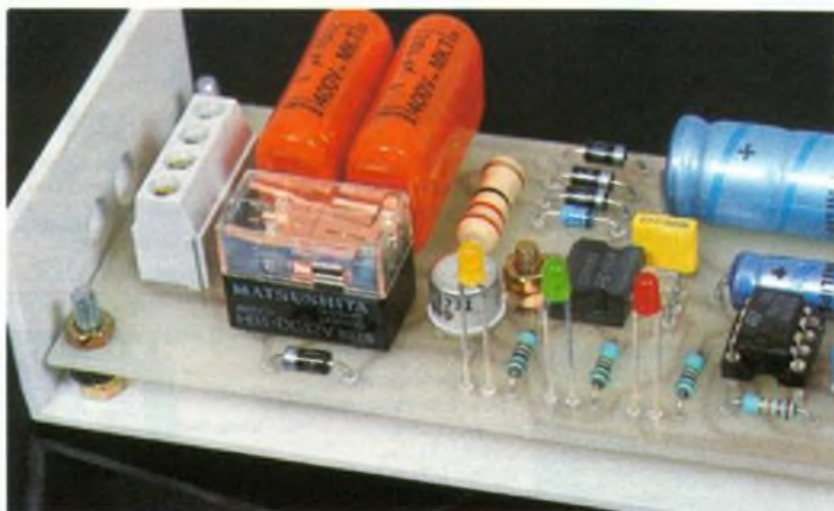
Photo 3 – Vue sur le relais de sortie.
