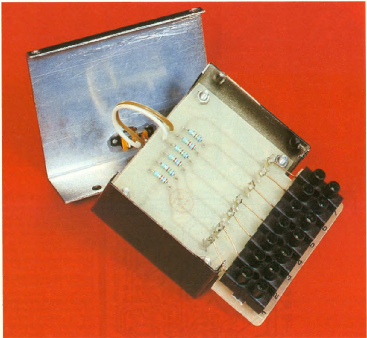
Photo 4. – L'autre boîtier ne renferme que des résistances.
