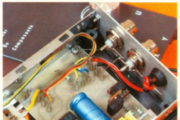
Photo 4 - Utilisation de fiche BNC « châssis ».
