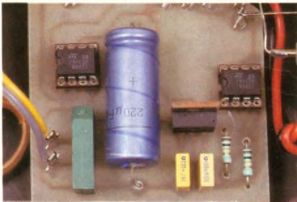
Photo 3 - Gros plan sur le pont redresseur (en vert)
