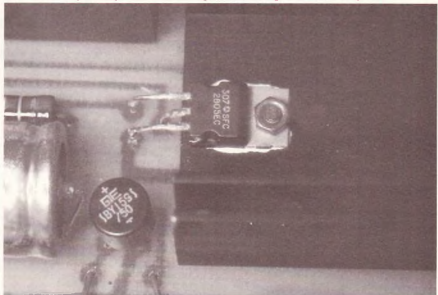
Photo 5. — Il faudra prévoir une bonne fixation du régulateur au dissipateur.
