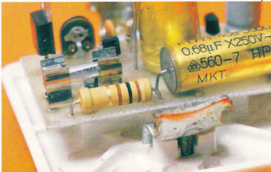
Photo 3. - La section alimentation 100 Ω/0,68 µF.
