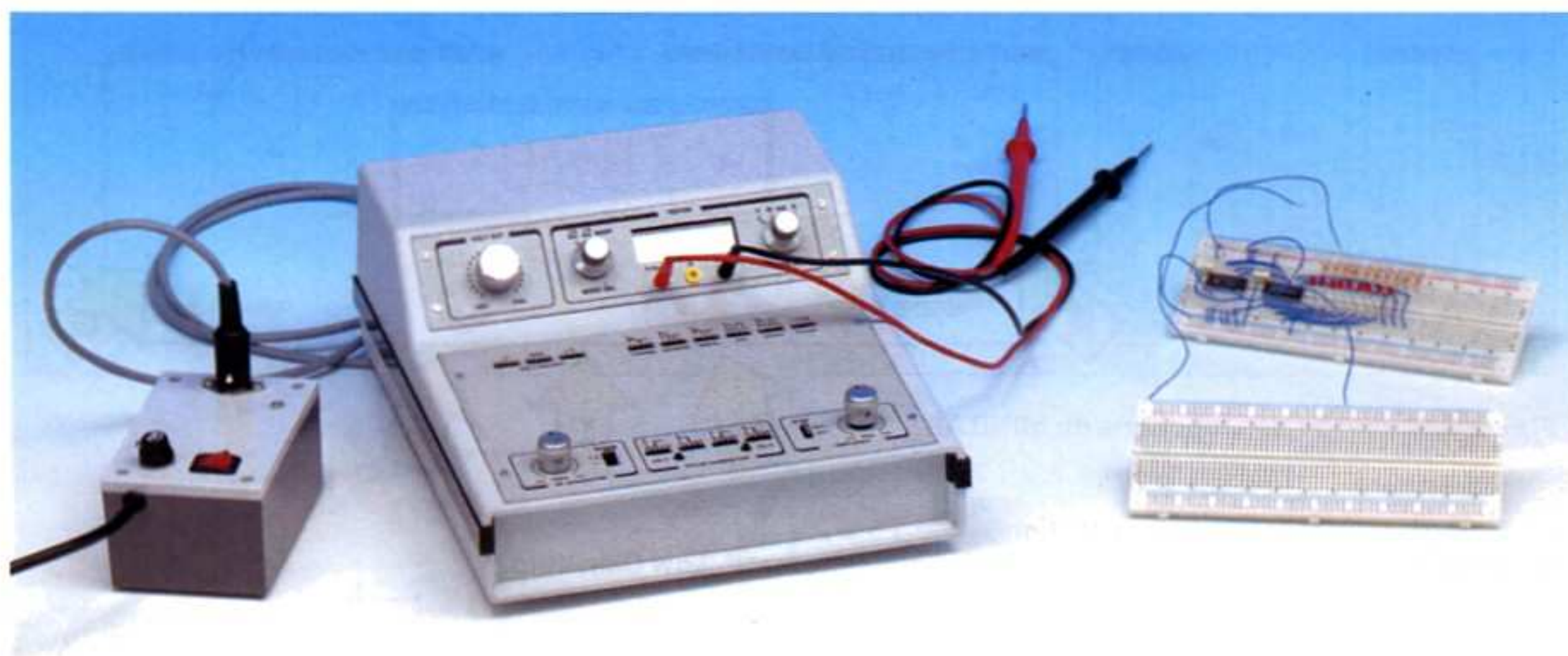
Figure 1 : Le MINILAB EN3000 est un véritable mini laboratoire d'électronique portable. Il est conçu et réalisé pour aider toute personne désireuse de se former à l'électronique en partant de zéro et à le faire de manière attrayante en mettant l'accent sur la pratique expérimentale. Avec les montages que nous vous proposerons dans les numéros d'ELM qui vont suivre, vous pourrez vous divertir tout en apprenant l'électronique : que ce soit en amateur ou en futur professionnel, vous allez vous éclater !
