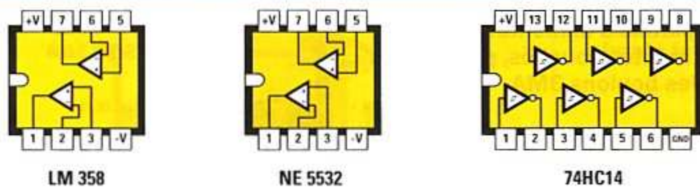
Figure 5 : Brochages des circuits intégrés NE5532, 74HC14, utilisés pour le générateur de fonction et du LM358 utilisé pour l'alimentation, vus de dessus et avec les repères détrompeurs en U orientés vers la gauche.
