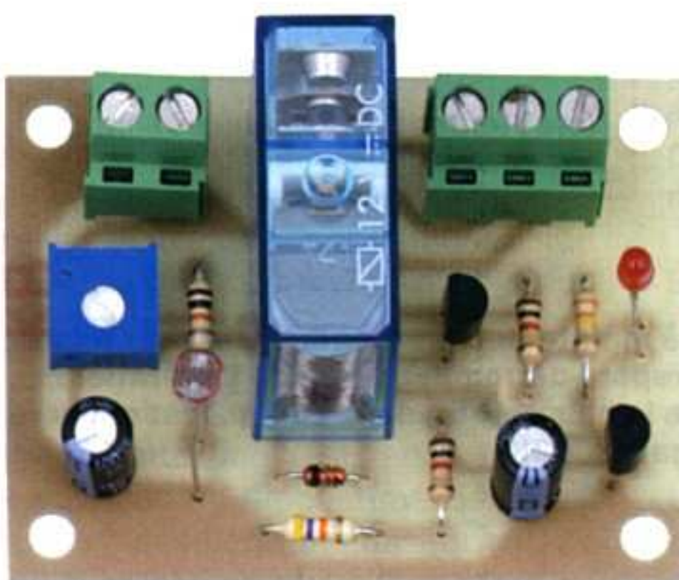
Figure 7 : Photo d'un des prototypes de la platine EN5061. Nous vous suggérons de l'installer, après montage de tous les composants, dans un boîtier plastique dans lequel vous ferez un trou pour le passage de la LED et un autre pour que la lumière puisse venir couvrir la surface photosensible de la photorésistance.
