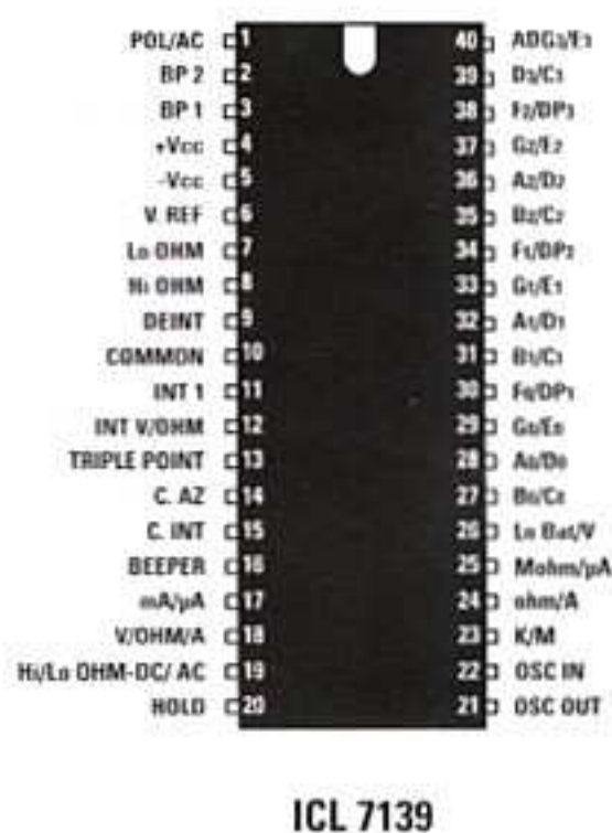
Figure 7 : Brochage du circuit intégré ICL7139 vu de dessous, dont les broches 23 à 40 pilotent l'afficheur LCD (à gauche) ; brochage du LCD vu de dessus et repère détrompeur orienté vers la gauche.
