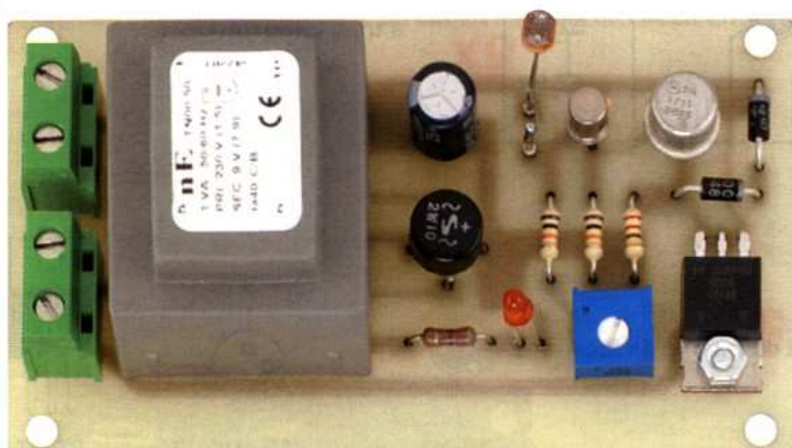
Figure 37 : Photo d'un des prototypes de la platine EN5070. Nous vous recommandons INSTAMMENT de l'installer, après montage de tous les composants, dans un petit boîtier plastique : en effet, les pistes du circuit imprimé et les composants sont sous la tension du secteur 230 V qui peut être mortelle.
