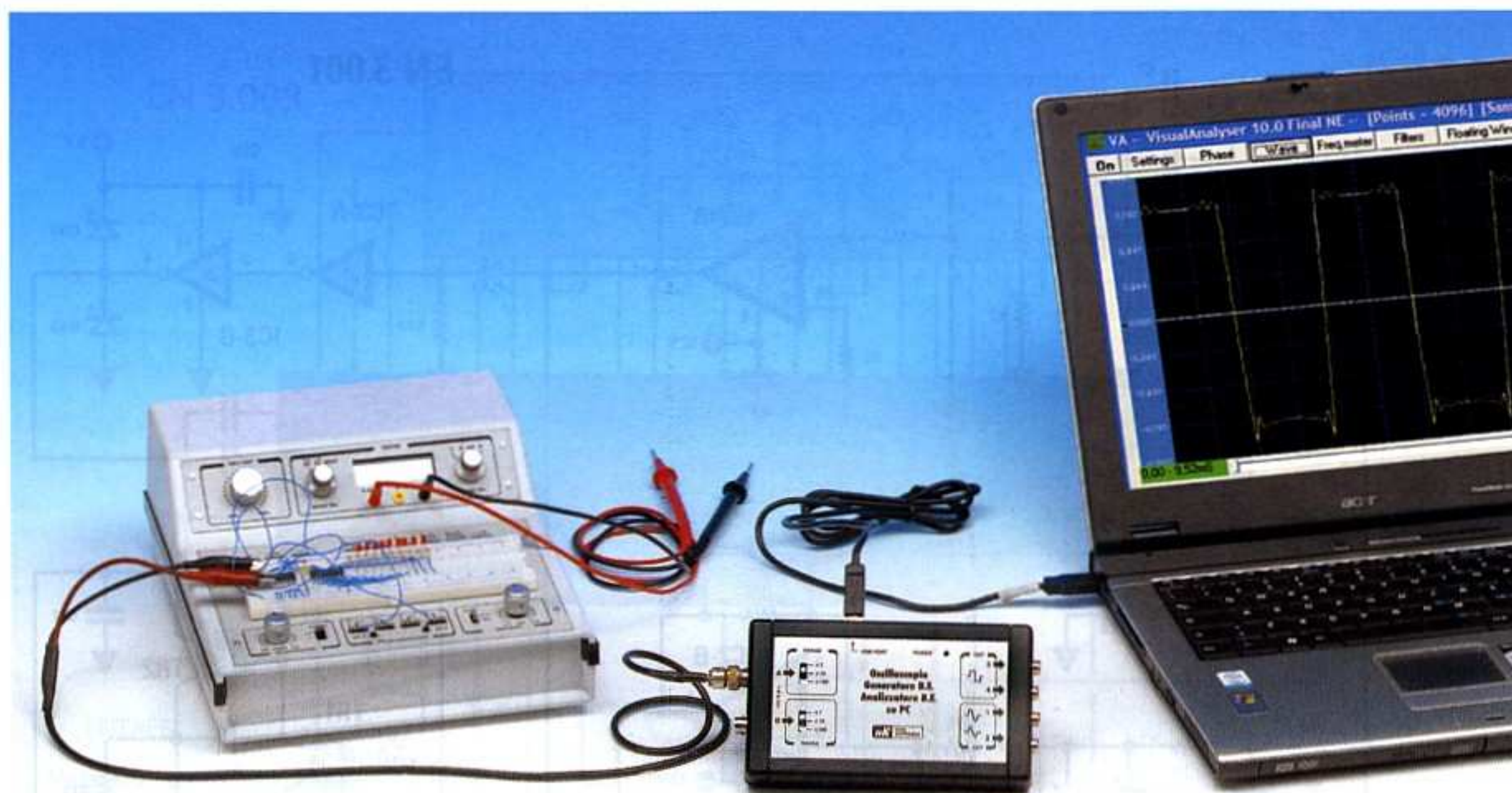
Figure 3 : Si vous disposez d'un PC et si vous reliez à sa prise USB notre interface EN1690, une fois le logiciel installé, vous disposerez du principal instrument de tout laboratoire d'électronique : l'oscilloscope. Vous pourrez «voir» les signaux électroniques à l'écran (de l'ordinateur devenu oscilloscope).
