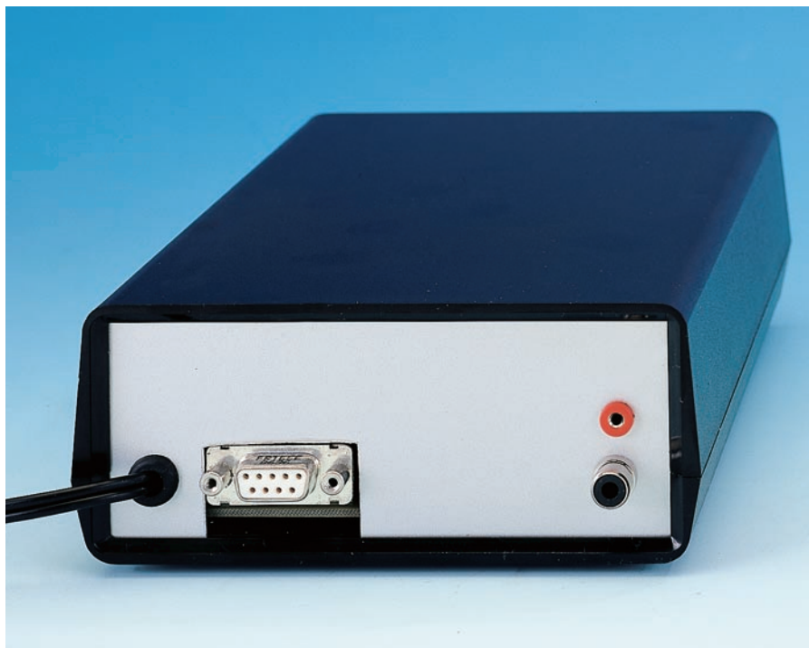
Figure 21: Du panneau arrière du boîtier sort le CONN1 servant à relier le connecteur mâle du câble sériel. Sur le côté droit du panneau arrière, on voit la douille d'entrée du câble coaxial et celle de sortie pour le +20 V (le - est constitué par la tresse de masse du câble coaxial).
