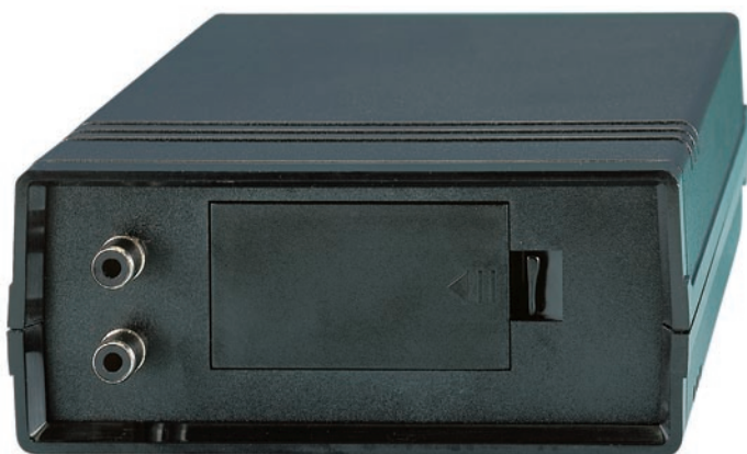
Figure 9 : Sur le panneau arrière en plastique, vous devez pratiquer deux trous (avec un foret à bois à pointe: ils font merveille dans le plastique ou la tôle d'aluminium, cependant pour cette dernière un avant-trou, avec un foret métal du diamètre de la pointe, est nécessaire) pour fixer les deux prises de sortie A et B. La petite porte donne accès au logement pour la pile 6F22 de 9 V, visible figure 8.
