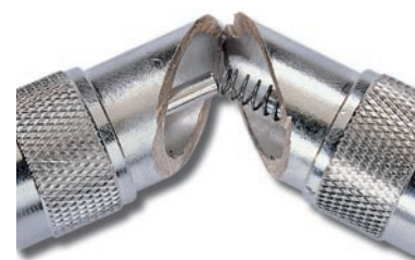
Figure 10 : Coupe d'un adaptateur N mâle/femelle économique. Son conducteur central d'entrée est électriquement relié à celui de sortie par un ressort en acier (fortes résistances de contacts et forte résistivité + réactance de la self en HF = pertes importantes, surtout en SHF).
