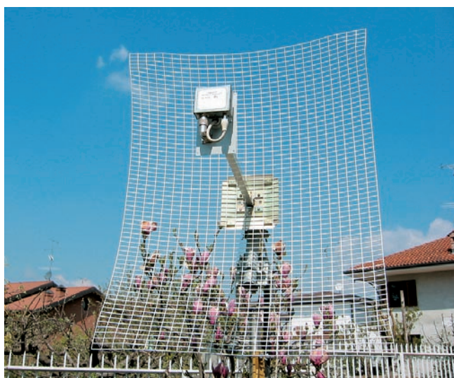
Figure 14 : Photo de la parabole complète, boîtier retiré afin d'apercevoir le convertisseur TV970 placé à l'envers du panneau.
