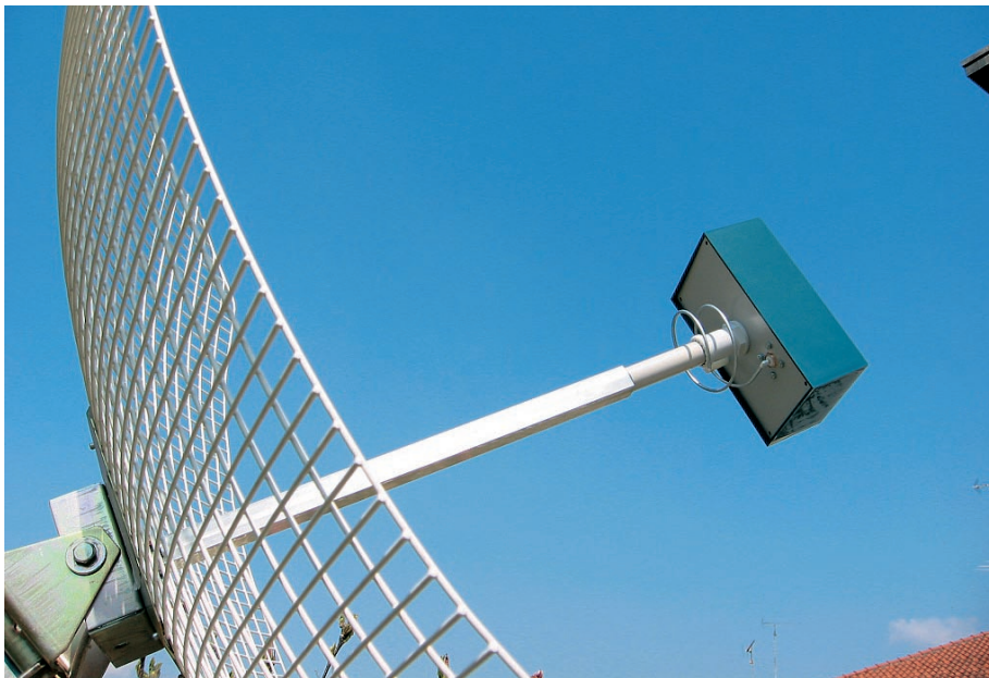
Figure 1 : La parabole complète avec son réflecteur et son illuminateur. L'illuminateur hélicoïdal est maintenu sur le point focal (au foyer) d'une quelconque parabole ronde ou grillagée, comme celle utilisée pour capter METEOSAT.
