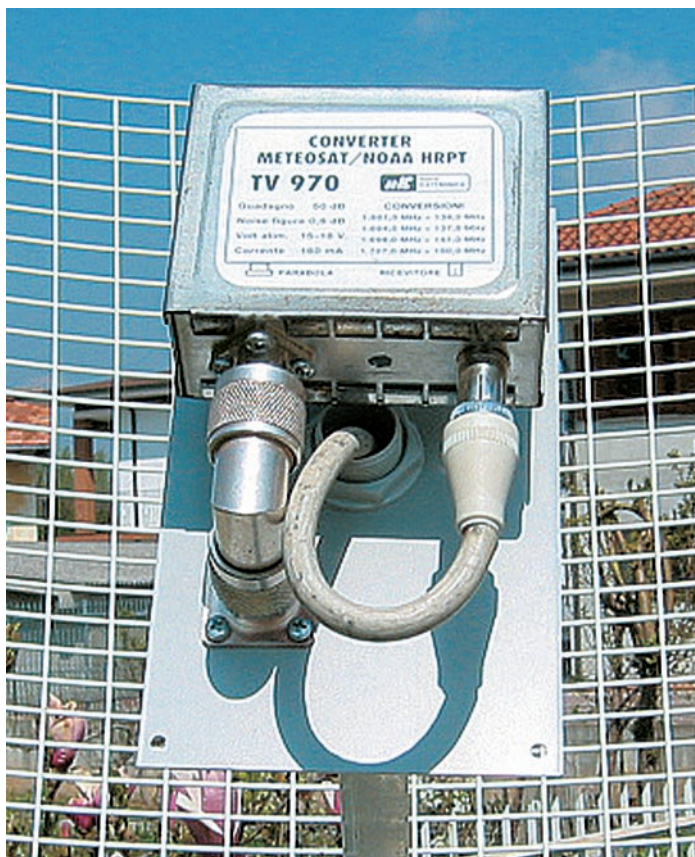
Figure 17 : Photo en gros plan de l'envers de l'illuminateur, montrant le convertisseur TV970.
