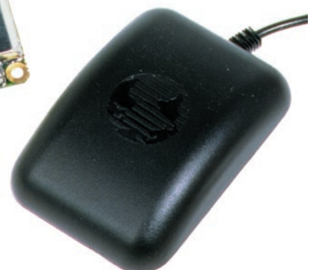
Figure 8 : Le GPS25 (à gauche) et son antenne GA27, utilisés avec notre platine d'essais.
