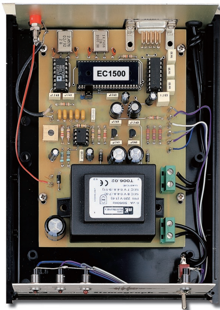
Figure 25: Photo d'un des prototypes de l'interface du sismographe installé dans son boîtier plastique avec face avant et panneau arrière percés et sérigraphiés (pour l'aspect final, voir la photo de première page). N'oubliez pas, si vous ne recherchez pas absolument le court-circuit, d'enfiler derrière le panneau la rondelle isolante plastique sur le fût de la douille "banane" avant de visser les deux écrous plats.
