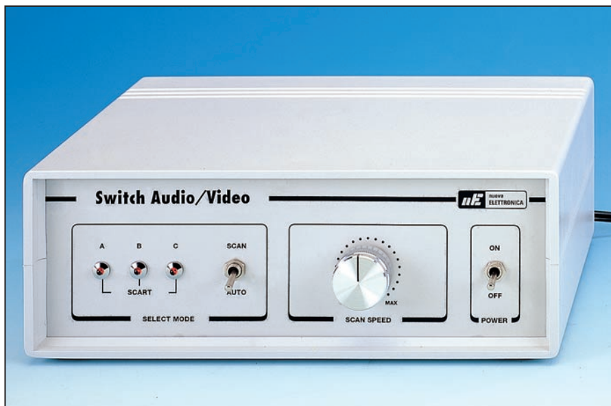
Figure 1: Photo du boîtier utilisé pour ce commutateur automatique capable de prélever le signal audio-vidéo de 3 prises péritel (SCART) différentes pour le transférer sur une unique sortie et vice-versa. Le bouton sert à faire varier la vitesse de balayage et les 3 LED A-B-C pour indiquer de laquelle des trois prises péritel A-B-C on prélève ou bien vers laquelle on transfère le signal audio-vidéo.
