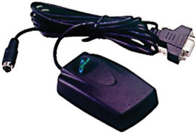
Figure 7 : Le GPS900 est un des deux récepteurs utilisés pour les essais avec notre platine d'expérimentation. A la différence du GPS25 (voir figure 8), cet appareil dispose d'une antenne incorporée.
