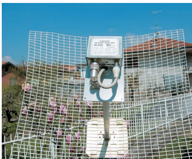
Figure 12 : La parabole complète vue de côté. Le boîtier de l'antenne avec son illuminateur hélicoïdal est placé au foyer de la parabole. Pour le modèle grillagé, le foyer est situé à 38-40 centimètres de la grille (distance non critique).
