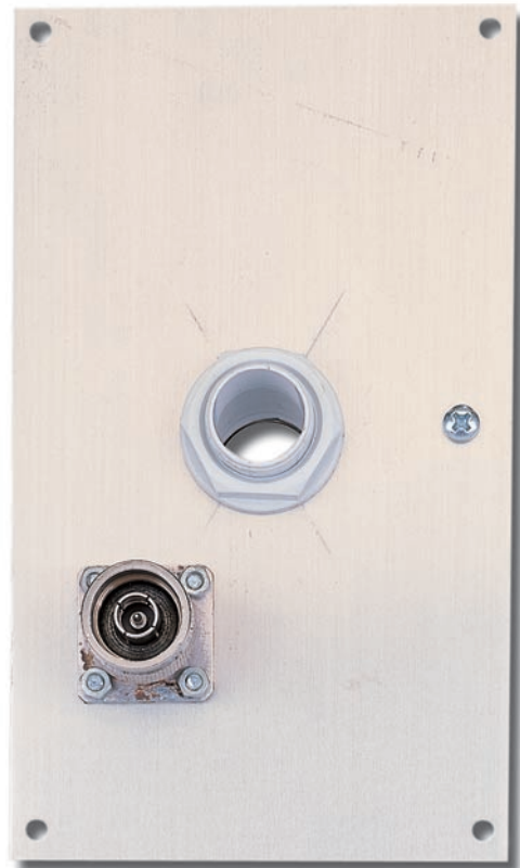
Figure 4 : Détails internes (envers du panneau). Au centre du panneau métallique du boîtier plastique MOX.11 choisi pour cette antenne, fixez un raccord plastique (facile à trouver au rayon électricité d'une grande surface de bricolage). En bas à gauche, fixez le connecteur N mâle (il doit être de type professionnel avec isolant Téflon, afin d'éviter qu'il ne fonde à la chaleur... du fer à souder ; de plus les pertes SHF seront bien moins importantes qu'avec du plastique ordinaire).
