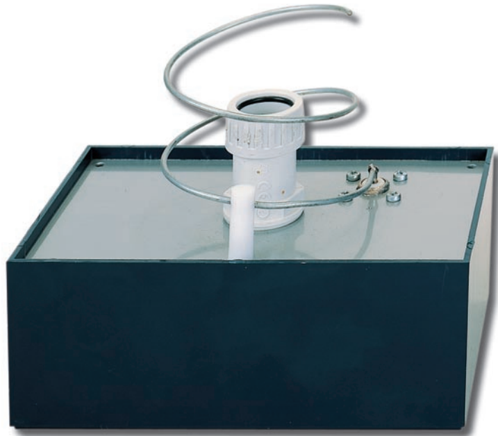
Figure 2 : L'illuminateur avec son boîtier et son hélice. Le panneau métallique frontal du boîtier plastique (la face avant) utilisé pour fixer les deux spires, est utilisé comme réflecteur pour le signal SHF.
