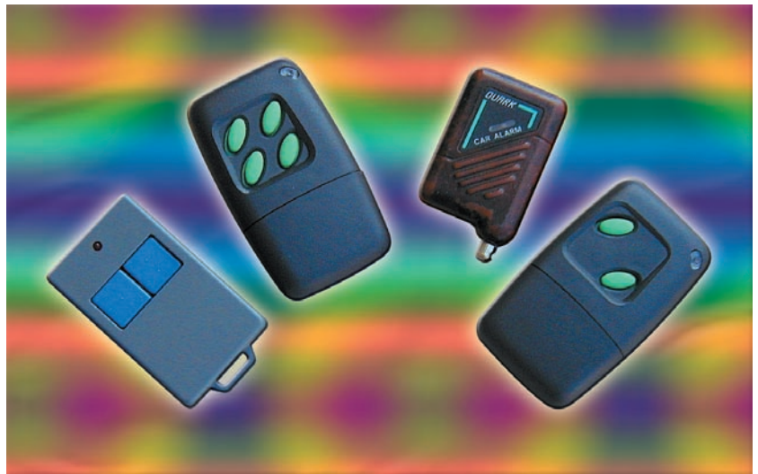
Figure 2: Quatre télécommandes porte-clés différentes. Notre répéteur fonctionne avec toutes les télécommandes codées MM53200/UM86409 ou MOTOROLA MC14502x. Par ailleurs, ce qui est vraiment intéressant, il permet d'activer un récepteur doté d'un type de codification différent de celui de la télécommande.
