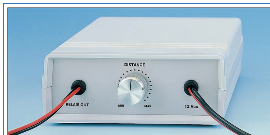
Figure 2 : Sur le panneau arrière du coffret se trouve le bouton du potentiomètre R7, utile pour déterminer la distance de travail.
