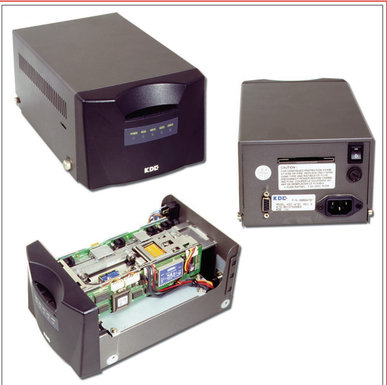
Figure 1 : Le KDT4700 comporte deux fentes. Une sur la face avant où l'on insère la carte à lire ou à inscrire. Le logiciel de gestion permet de choisir si l'on veut récupérer la carte par la même fente ou par l'autre, située sur le panneau arrière.
