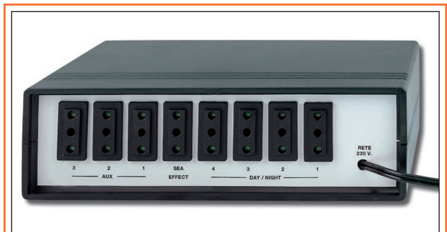
Figure 2 : Sur le panneau arrière du coffret se trouvent 8 prises 220 volts (voir inscriptions "AUX 1, 2 et 3", "SEA EFFECT", "DAY/NIGHT 1, 2, 3 et 4") qui sont directement alimentées par les relais reliés à la tension secteur, comme vous pouvez le voir à la figure 4.
