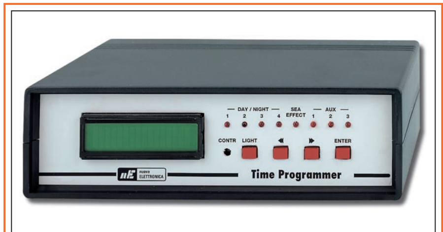
Figure 1 : Sur le panneau avant de ce temporisateur se trouvent un afficheur LCD et quatre boutons poussoirs qui vous permettront de programmer les temps d'allumage et d'extinction. Chaque fois qu'un relais est excité, une LED s'allume sur le panneau avant.
