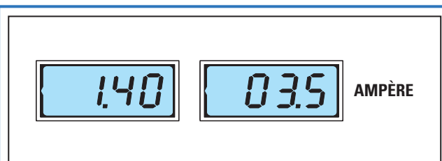
Figure 10 : Si le courant absorbé ne dépasse pas 2 A, le LCD affichera 2 décimales (exemple : 1,40 A). S'il les dépasse, le LCD affichera 1 seule décimale (exemple : 03,5 A).
