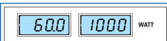
Figure 13 : Pour la mesure des watts, le LCD affiche 3 chiffres et une décimale pour les puissances inférieures à 450 W et 4 chiffres sans décimale pour les puissances au delà.
