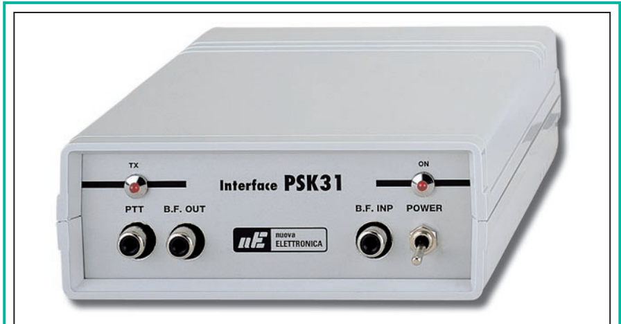
Figure 1 : Photo de notre interface pour le PSK31 une fois le montage terminé.
