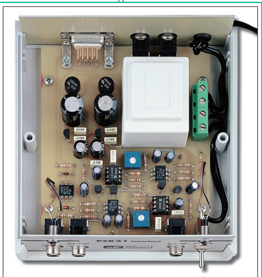
Figure 4 : La platine de l'interface est fixée à l'intérieur du boîtier plastique à l'aide de quatre vis autotaraudeuses. Sur la face avant sont placées les deux montures chromées pour les deux diodes LED, DL1 et DL2.
