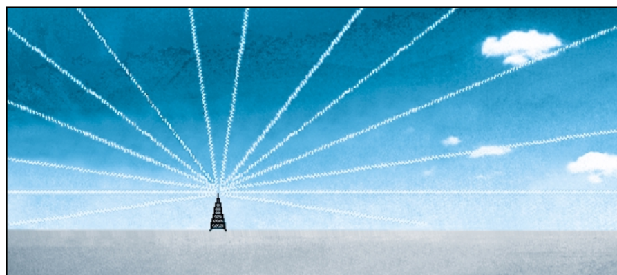
Figure 284 : Les ondes radio rayonnent de l'antenne émettrice dans toutes les directions. Les ondes radio qui suivent la surface terrestre sont appelées "ondes de sol" ou "de surface", tandis que celles qui rayonnent vers le ciel sont appelées "ondes spatiales".
