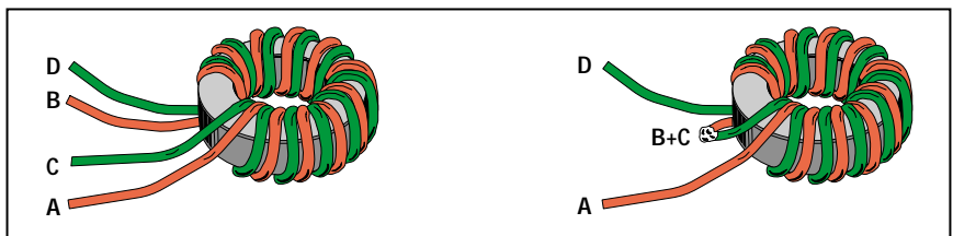
Figure 4 : Le transformateur T1 s'obtient en enroulant 10 spires 2 fils, gainés plastique, en mains sur un tore de ferrite FT50.43.
