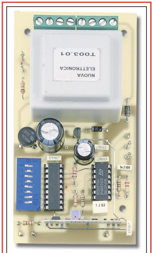
Figure 13 : Vue du récepteur, une fois le montage terminé. Les leviers du dip-switch S1, sont positionnés de la même façon que ceux de l'émetteur.
