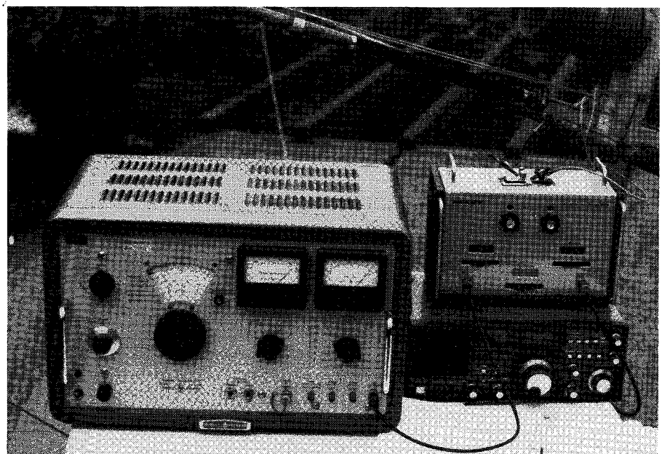
Fig. 10. Meten van de impedantie van een vierkant met de meetbrug van Wayne Kerr. De brug wordt gevoed door een signaalgenerator. Als detector dient een communicatie-ontvanger (foto: PAoSE).
