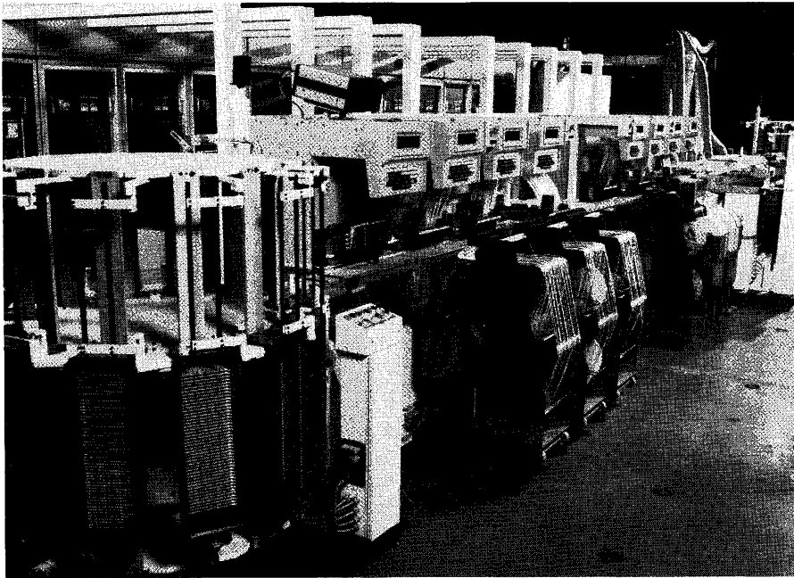
Fig. 2. Een opstelling van door Philips gefabriceerde machines voor het plaatsen van Surface Mounted Devices. Al naar gelang het type is zo'n MCM-machine geschikt voor het plaatsen van zo'n 30.000 tot 500.000 componenten per uur (foto: Philips Persdienst).
