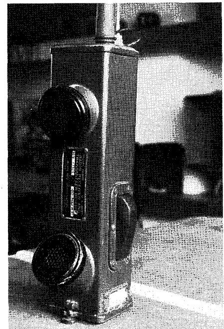
Foto 2. De BC-611 van nabij. Achter de bult op de zijkant bevindt zich de zend-ontvangschakelaar.
