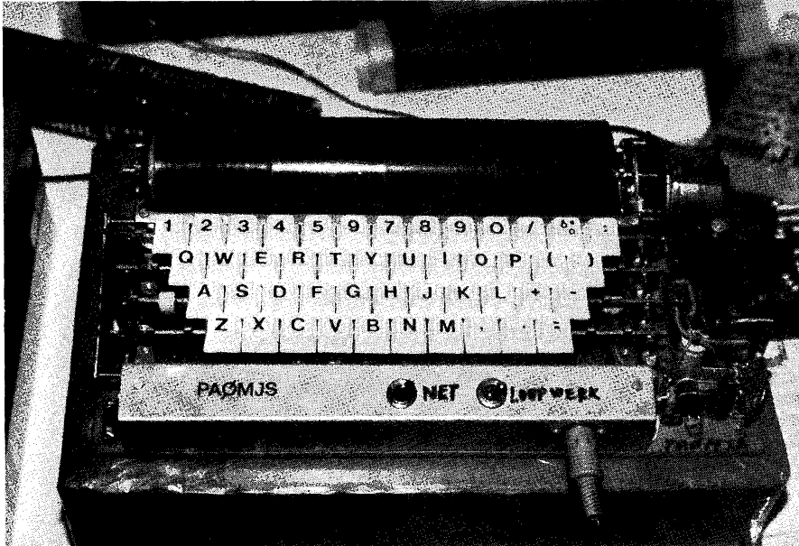
Foto 6. Hellzender van PAoMJS. Achteraan het toestel de codewals waarmee langs elektronische weg de tekens worden gegenereerd. (Foto PAoSE).
