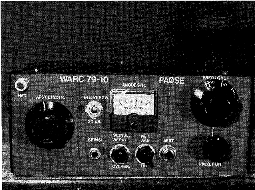
Foto 2. Het instellen van de zendfrequentie gebeurt met twee knoppen voor grof- en fijninstelling. Zo is een dure en moeilijk te krijgen knop met vertraging vermeden.
