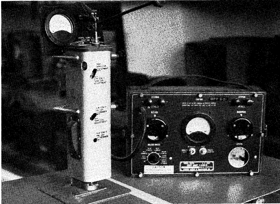
Foto 5. Opstelling voor het afregelen van de BC-611.
