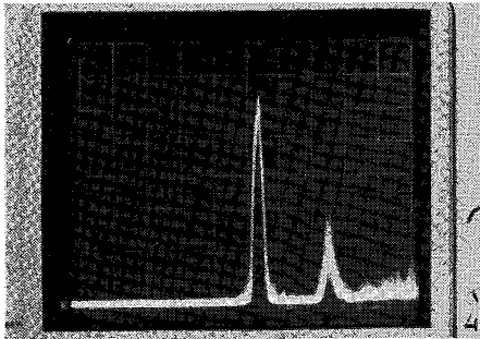
Foto 4. Ongemoduleerde geluidsdraaggolf met rechts daarvan de kleur-hulpdraaggolf.
