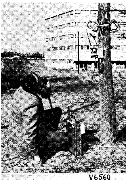
Fig. 5. De boom straalt een signaal uit op 10,803 MHz. Energie van de zender wordt op de boom overgebracht via een aanpassingsnetwerk in de doos met meter en een speciaal koppellement in de vorm van een toroïde, rondom de boom, dat „Hemac“ wordt genoemd. Op dezelfde manier kunnen ook lantaarnpalen en andere objecten, zelfs mensen, als antenne worden gebruikt.
