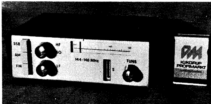
Twoe meter ontvanger in mini-uitvoering. Op deze foto ziet u de enigszins overstekende kap. Over de wijze van letteraanduiding leest u meer in het artikel. (Foto PAoVDP)
