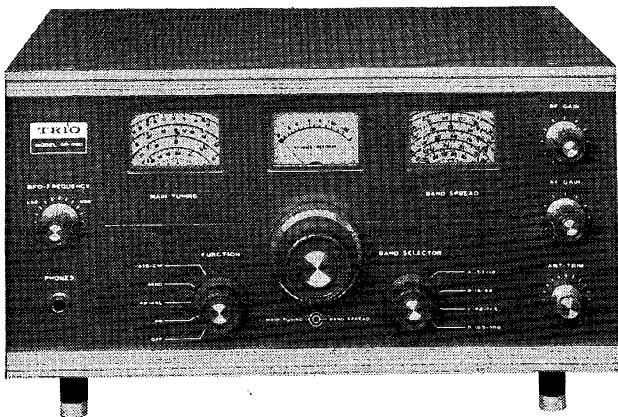
9R - 59 D Communicatie-ontvanger met 8 buizen m.f. bandfilters, produktdetector.
