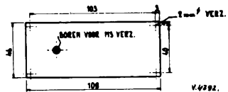
Maatschets van het kastje van de beschreven peilontvanger voor de 2 m band. Maten in mm. Zowel kastje als deksel zijn van messing (voor het kastje 1 mm dik, voor deksel 2 mm dik)
