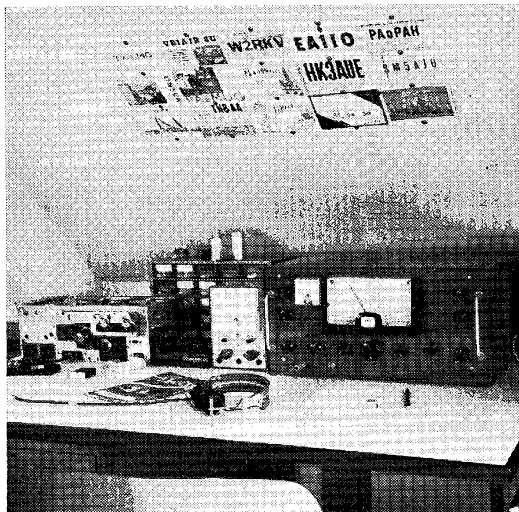
De shack van NL-528. Op deze foto ziet u de shack van het luisterstation NL-528, operator Jan Mooy. Van links naar rechts een BC624-A 2 m ontvanger (gewijzigd), een opbergkastje, de RCA buisvoltmeter WV-77E en de Philips ontvanger 2010
