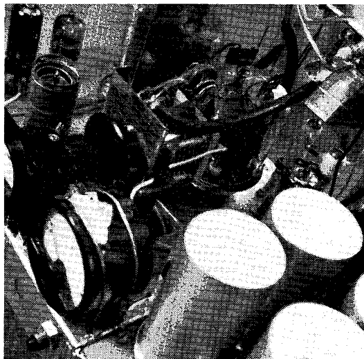
Eindtrap met anodekring. Op de voorgrond de elco's van de voeding. Voor het maken van deze foto is de EL34 - halfweg tussen 82-B en de linkse elco - verwijderd. De bedoeling was, dat hierdoor een van de neutrodyncondensatoren - donker draadje onder de afstemcondensator - zichtbaar werd. Links boven enige buizen van de stuurtrap. De rest hiervan gaat schuil achter het schot waarin vaag de 829-B weerspiegeld wordt. (Foto: PAoIF.)
