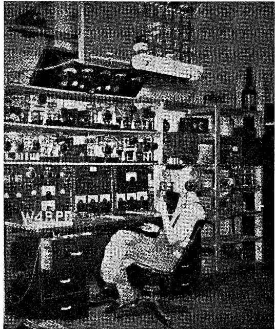
'Sir' Gus, W4BPD, anno 1946. Dit is een foto van het station W4BPD, zoals we die aantreffen in een oud nummer van QST. Reeds in 1946 was Gus Browning op praktisch alle banden in de lucht. Aparte eindtrappen voor 80, 40, 20, 11 en 10 m bevatten alle een paar 813's die een tweetal 304TL's stuurden...
