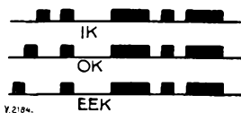
Fig. 1. De juiste wijze, waarop bij de Amerikaanse Morse-code het signaal „OK” geseind moest worden. Een normale rust tussen de beide eerste punten geeft „IK”, een te lange rust „EEK”.
