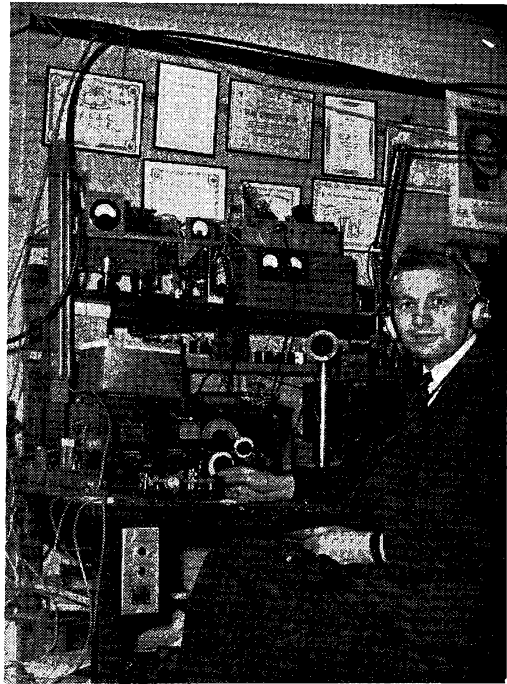
De shack van G3BLP: op de plank boven de tafel staat de 2 m zender, cc op 144.970 MHz, met EF55 CO-tripler, EL91 tripler, EL91 doubler, 832 buffer, 2 × 826 PA, input 100-120 Watt. Anodemodulatie met 2 × 805 in Class B. Op de tafel, van links naar rechts: „cascode” converter met c.c. oscillator, bestaande uit 6AK5 genuetrodyniseerde H.F.-trap (triode), EC91 geaard rooster 2e H.F.-trap, 6AK5 penthode mixer, 6J6 kristal-oscillator op 29,5 MHz met de 2e helft van de 6J6 quadrupling naar 118 MHz, en output hiervan inductief gekoppeld met 't stuurrooster van de 6AK5 mixer; ontvanger type E53b als 1e (afstembare) M.F.-versterker van 26-28 MHz; BC348 ontvanger als 2e M.F.-versterker op 4 MHz. DL-104 kristal-microfoon op de tafel.
