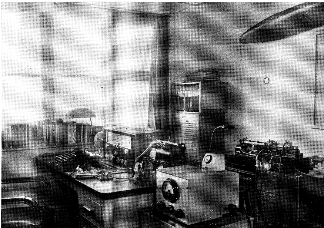
Een hoekje van het radio-station van een groot illegaal blad. De berichten werden radiotelegrafisch direct met de schrijfmachine opgenomen en radiotelefonisch met behulp van dictaphones. Nadat de electriciteitsvoorziening was weggefallen, zorgde een windcharger voor de noodige stroomverzorging. Ook de berichten betreffende de „droppings” van wapenen enz. werden hier opgenomen
