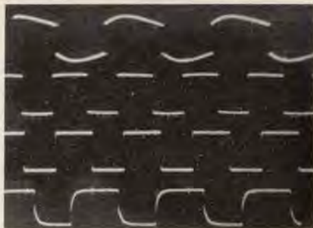
Figura 14 Dall'alto in basso, risposta ai segnali rettangolari a 30 Hz, a 100 Hz, a 1 e a 20 kHz rilevati ai capi del carico dell'amplificatore di figura 13.
