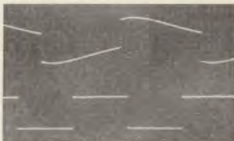
Figura 17 Risposta ai segnali rettangolari a 20 Hz (in alto) e 200 Hz (in basso) trasmesse dall'amplificatore di figura 15.
