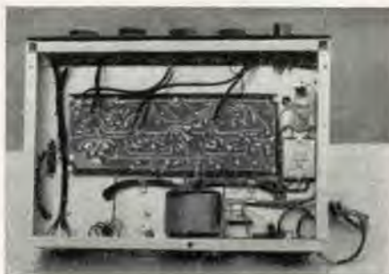
Amplificatore «atlas» da 6+6 watt: vista sotto il telaio con il circuito stampato e i cablaggi della alimentazione
