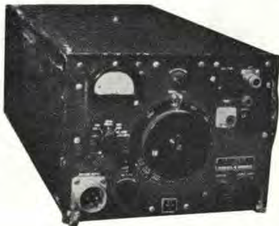
R 111/APR-5 - ricevitore per la gamma 1000 ÷ 6000 MHz (mille - seimila MHz!)
