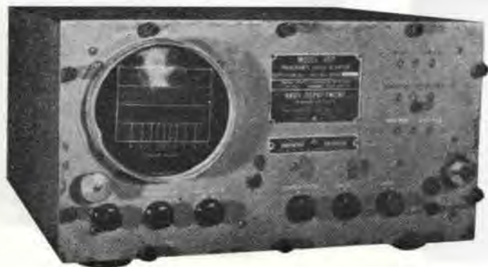
RDP - adattatore panoramico per l'uso col ricevitore APR4.
