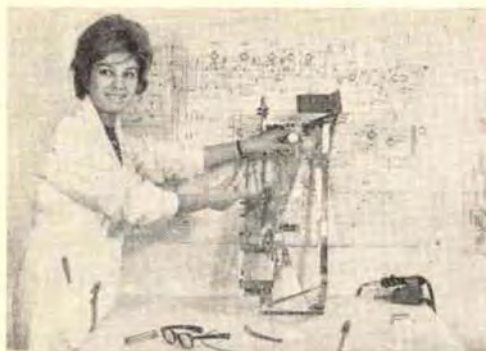
Montaggio dei condensatori « a vite ».
