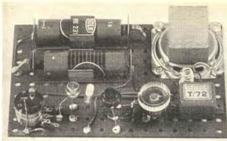
Aspetto del montaggio dell'amplificatore. L'altoparlante miniatura non è necessario, anzi può essere sostituito con vantaggio da un modello normale con cono più ampio.
