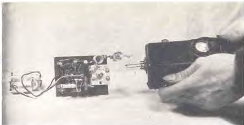
Messa a punto del rice - trasmettitore eseguita usando l'ondametro di cui alla pag. 14.
