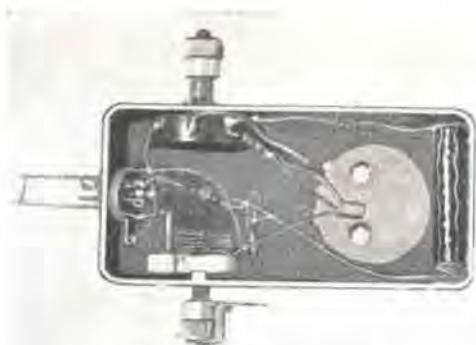
Interno dell'ondametro: a destra il fondello del microamperometro, a sinistra i controlli: variabile e potenziometro per l'azzeramento.
