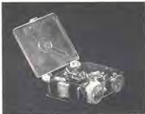
Ricevitore con il coperchio sollevato per l'ascolto. Si noti la ferrite a sinistra.
