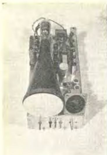
Telesvisore fronte: Si no- tino i comandi che sporgono sotto al tubo
