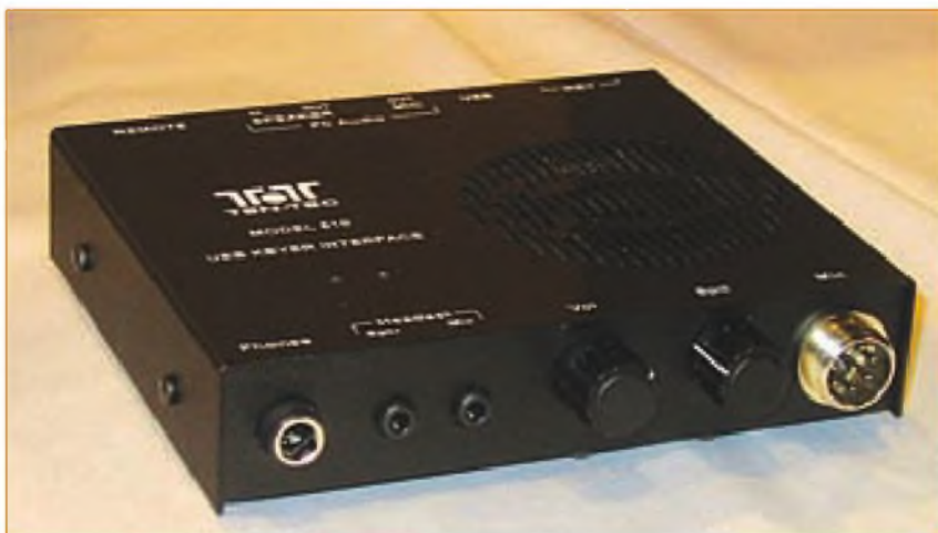
Foto L. La Interface 610 de Ten-Tec es una interfaz USB que permite utilizar manipuladores de palas, micrófonos y auriculares desde un PC remoto y manejar otros controles de un transceptor Omni-VII como si estuvieras presente.
