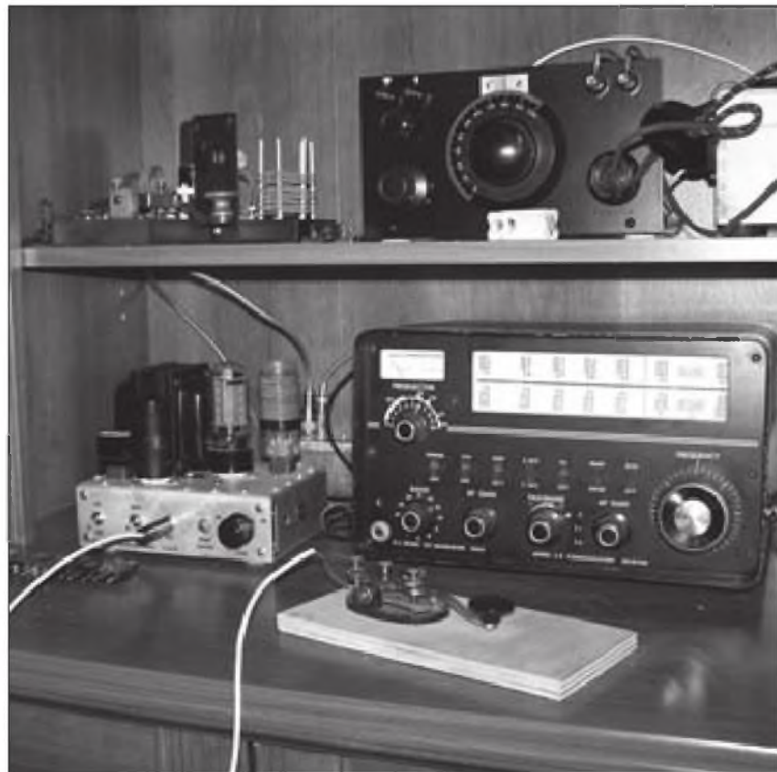
Foto D.- Una mirada por encima del transmisor de KB5ZO permite admirar la cuidadosa disposición de sus componentes, así como el que va siendo ya un raro elemento, el transformador, cada día más difícil de encontrar. Éste es un modelo con "tres dedos" de grueso de chapas, o sea, capaz para entregar "300 mA", tal como los evaluábamos en los viejos tiempos.
