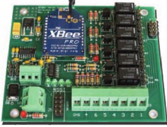
Foto G. Green Heron Engineering presenta un controlador sin hilos para manejar desde la estación los relés de conmutación de antenas en lo alto de la torreta sin necesidad de múltiples bajadas. Esta placa es el corazón del sistema y va montado en una caja estanca.
