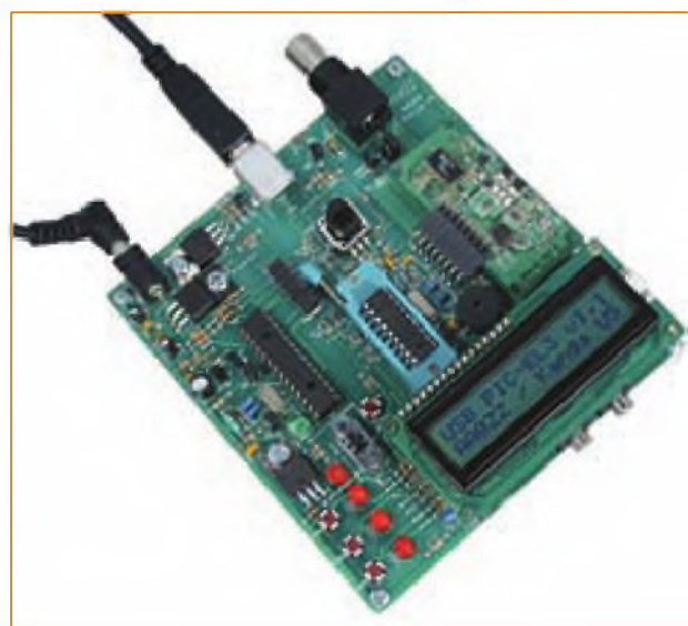
Foto M. Procedente de Kanga US, el programador PIC-EL III de AA0ZZ. Vea el texto para obtener más detalles.
