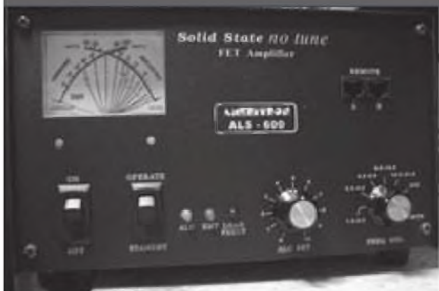
Foto A. El ALS-600 proporciona 600 W PEP en SSB desde 1,8 a 30 MHz. Los jacks RJ45 (REMOTE) del panel permiten el control remoto del mismo.
