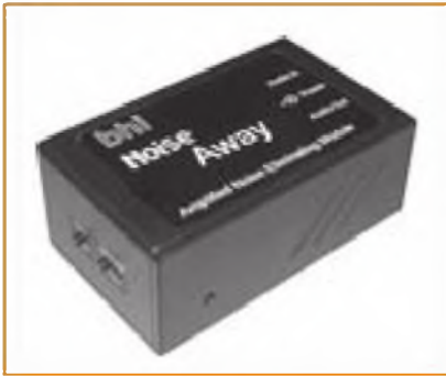
Foto I. El supresor de ruido ANEM MKII es un módulo externo que filtra los ruidos captados por el receptor.
