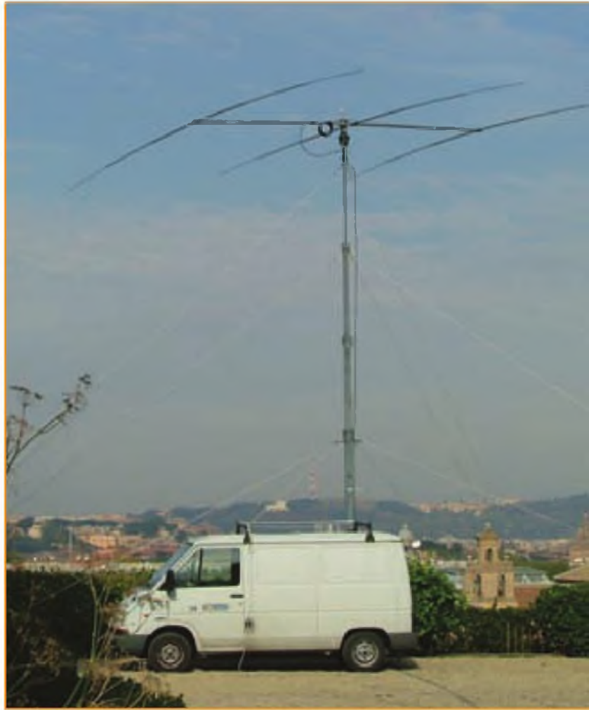
Foto 3. La Yagi de 20 metros (mostrada aquí) y la directiva para 15 metros tenían ambas excelentes vistas desde la colina del Aventino para alcanzar Japón por el camino largo.
