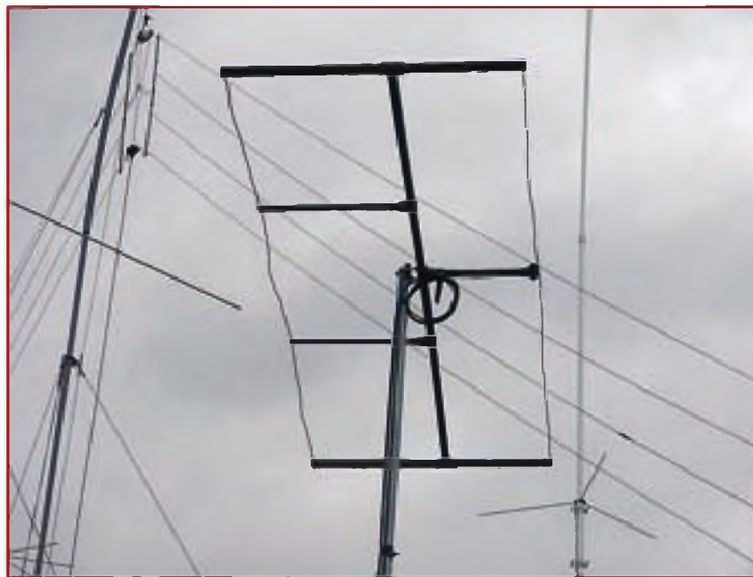
Foto A. Antena Moxon para la banda de 6 metros, lista para operar.
