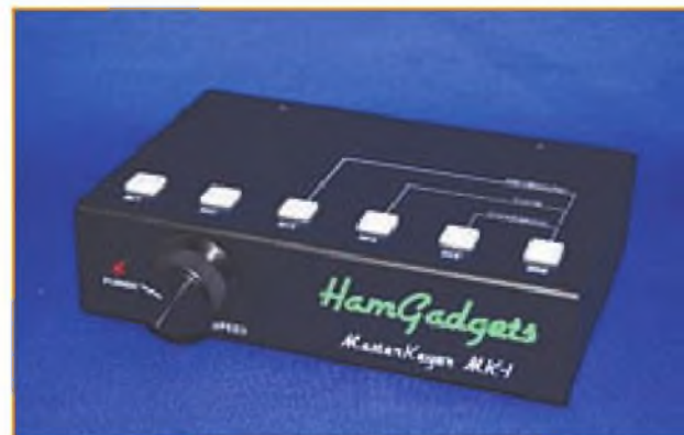
Foto N. Un manipulador electrónico con muchas memorias, el MasterKeyer MK-1 de Hamgadgets.com.
