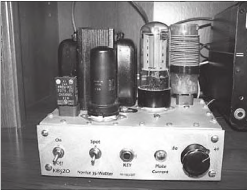
Foto C.- Reuben Staff KB5ZO sobrepasó todo lo imaginable al construir este transmisor de dos válvulas, con una 6AG7 excitando una 6L6, en un chasis metálico. Esta pequeña joya emplea bobinas enchufables, dos zócalos para cristales y saca 14 vatios en 40 metros y 22 en la banda de 80. Nótese el empleo de una lámpara piloto en vez de instrumento como indicador de la corriente de placa. ¡Clase total! (Las fotos C, D y E son cortesía de KB50)
