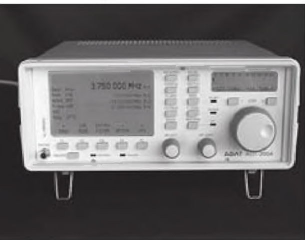
Foto A. Panel frontal del transceptor digital ADT-200A. Foto cortesía de ADAT.
