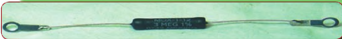
Foto A. La resistencia de 3 M lista para ser montada en mi dipolo tribanda.
