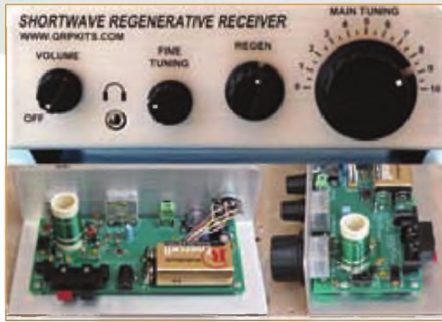
Foto Q. El Scout Regen Receiver de Hendricks QRP Kits es un sencillo receptor regenerativo de dos bandas para montar en kit.
