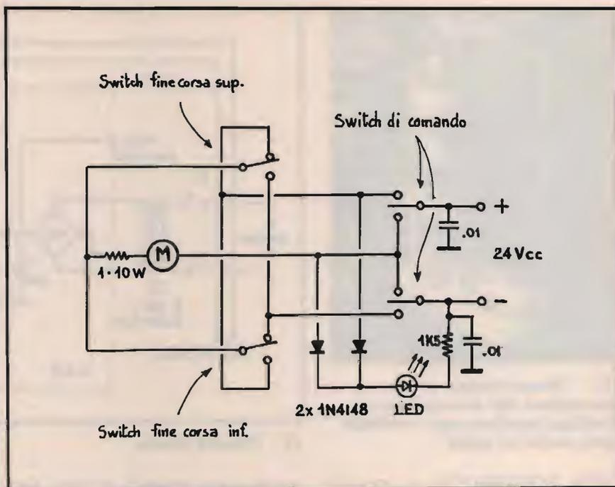
④ Circuito di controllo dei servomotori relativi ai condensatori variabili "Jennings" del  $\pi$  d'uscita.
