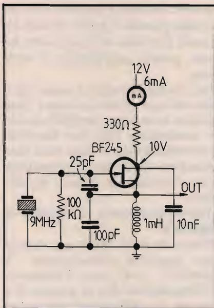
⑤ Rispetto alla figura 4, si sono aggiunti i due capacitori di feedback e il quarzo. Se il circuito oscilla, deve diminuire la corrente di drain che provoca un aumento della tensione di drain. Se il feedback è troppo forte, si aumenta il valore del capacitore da 100 pF. L'impedenza da 1 mH può essere sostituita con un resistore.
