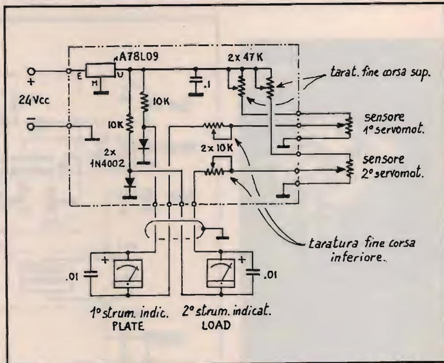
⑤ C.S.6: Circuito adattatore indic. capacità di accordo del  $\pi$  d'uscita.
