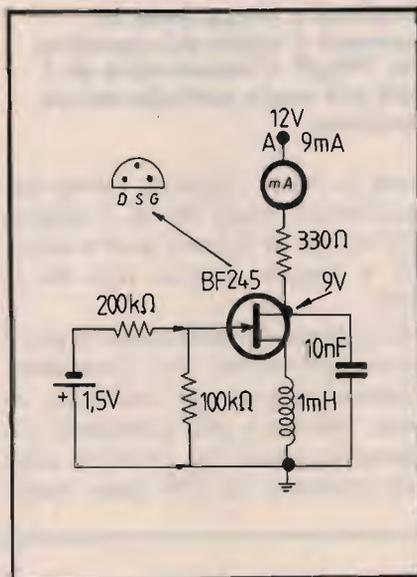
④ Per ridurre al minimo le possibilità di insuccesso, conviene montare dapprima la "sezione amplificatrice" di un circuito oscillatorio. Dopo esserci accertati che tutto funziona, si montano gli altri componenti, cioè la rete di feedback. Notare la corrente e tensione di drain, che devono essere differenti quando il circuito oscilla. La batteria serve per calcolare la conduttanza mutua (non dimenticare il resistore di protezione da 200 kohm).
