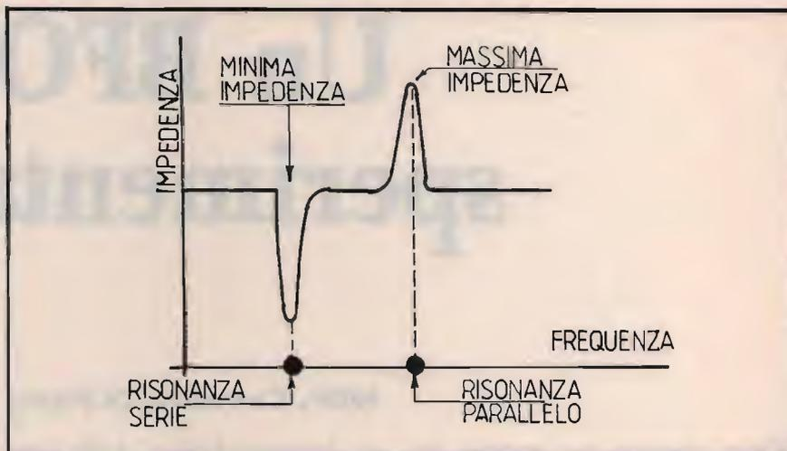
② **Curva dell'impedenza di un quarzo. Nel punto di minima impedenza si ha la risonanza "serie". Nel punto di massima impedenza si ha la risonanza "parallelo". Le due risonanze sono vicinissime fra loro (la curva non è in scala per ragioni di chiarezza).**
