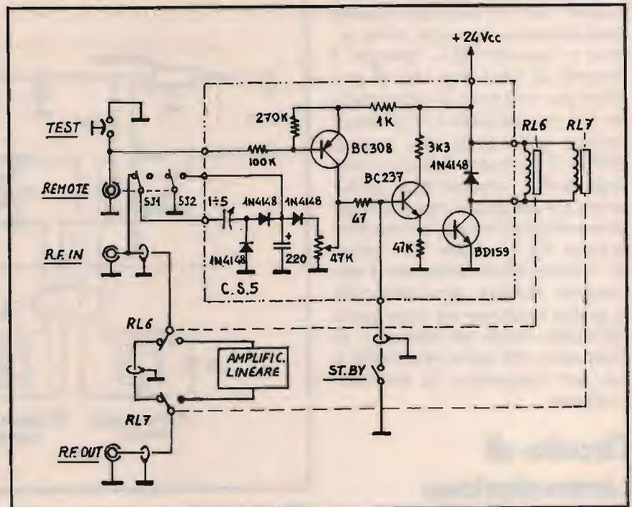
③ C.S.5.: Circuito Commutatore d'antenna.
