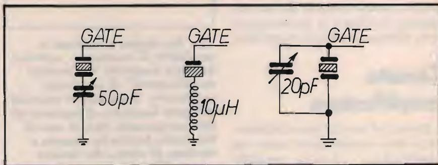
⑥ Tre metodi per modificare la frequenza del quarzo. A sinistra, con un capacitore in parallelo la frequenza diminuisce. Al centro, con un capacitore in serie la frequenza aumenta. A destra, con una induttanza in serie la frequenza diminuisce.
