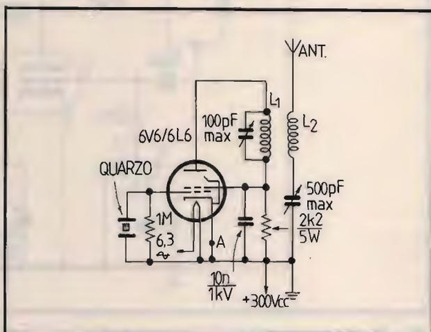
① Un semplice trasmettitore a valvola per HF; la potenza d'uscita è di qualche watt.
