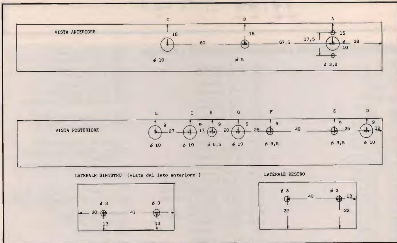
① PIANO DI FORATURA DEL CONTENITORE TEK0 "399" per il MODULO DI CONVERSIONE A 9000 kHz le quote sono espresse in mm.
