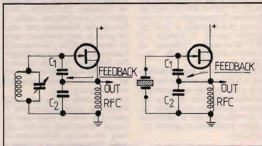
③ **Schema di principio di un oscillatore libero (VFO) e del corrispondente oscillatore quarzato. Un quarzo corrisponde ad un circuito LC ad altissimo Q. Per questo oscilla con un minimo di feedback, che è determinato dal rapporto  $C_2/C_1$  (oscillatore Colpitts).**
